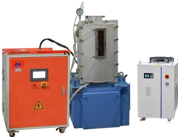
GRF-50 高温石墨化炉由感应电源、真空腔体、真空泵、控温系统、水冷却系统组成。设备的电气部分、冷却系统、真空系统、温度测控系统可通过 PLC 与上位机实现无缝连接，实时监视、控制并显示整套设备的运行情况
