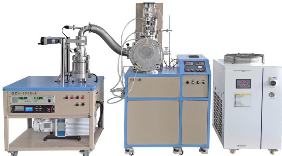
RTP-M1 是一款小型的超快速高真空热压炉，压力可电动调节。有手动和自动两种加热方式，手动最快升温速率可达 200℃/S，最高温度可达 2900℃。它是一款可在快速加热和快速降温条件下研究材料性能的设备。
