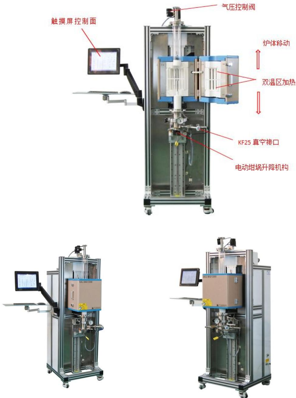
SKJ-BG-1200 是一款小型的 1200°C 布里奇曼单晶生长炉，配有内径  $\Phi 72\text{mm}$  石英管和精密炉体移动机构（最大行程 200mm），此设备设计用于在气氛控制环境下生长小尺寸的单晶或材料定向凝固。
