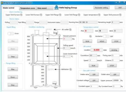
触摸屏控制面板可控制炉体移动速度，移动行程和炉体温度和显示坩埚的温度，也可控制炉管内部气压
