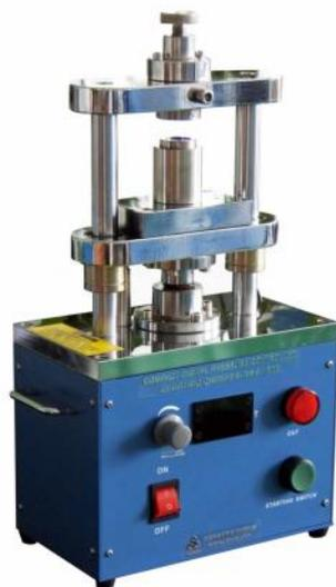
MSK-160E 是一款小型的压力控制性电动纽扣电池封装机，可用于封装 CR2016,CR2025 和 CR2032 扣式电池。此设备采用 24V 直流电机驱动，可在 Ar 环境下的手套箱内使用，用于资助 Li-S, 锂空气和锂离子半电池的测试。数字压力控制器，可保证每次封装时的封装压力一致。这款封装机的尺寸较小，可以通过手套箱的过度仓进出手套箱。
